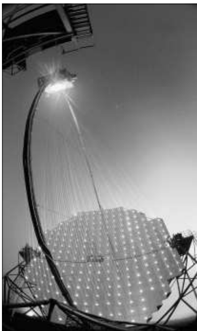
Il telescopio Magic allestito all'Osservatorio del Roque de los Muchachos sull'isola di La Palma, nell'arcipelago delle Canarie, e il suo sistema laser di controllo attivo di puntamento degli specchi. A destra un buco nero in una rappresentazione artistica della Nasa
