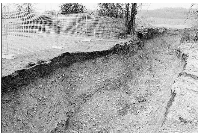
Lo scavo effettuato a Lestans per l'indagine geologica e sismologica
